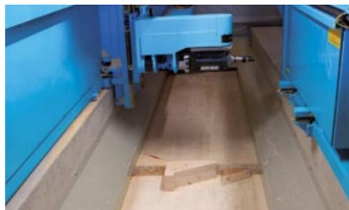
Die nach unten in den Entsorgungskanal fallenden Späne und Resthölzer werden mit einem in den Maschinenablauf integrierten Querschieber sicher und effektiv aus der Bearbeitungszone gefördert und nachfolgenden Entsorgungslösungen zugeführt, wie z.B. einem Hacker oder einem Steigförderband zu einem Spänecontainer.
