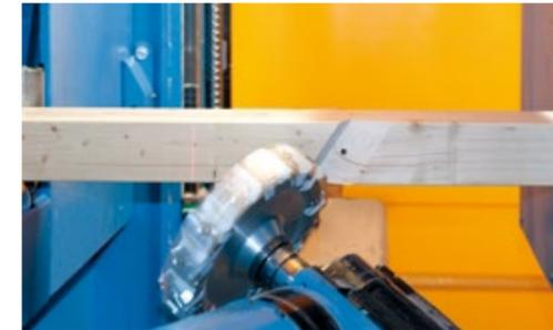
Durch die besondere Konstruktion der Maschine kann das äußerst stabile ROBOT-Aggregat die Bauteile uneingeschränkt von allen 6 Bauteilseiten anfahren und in allen möglichen Winkeln und Neigungen bearbeiten. Das sonst oft notwendige Wenden der Bauteile oder sogar ein 2. Durchlauf entfällt selbst bei den größten Holzquerschnitten. Absolute Genauigkeit und Präzision sind das Ergebnis.
