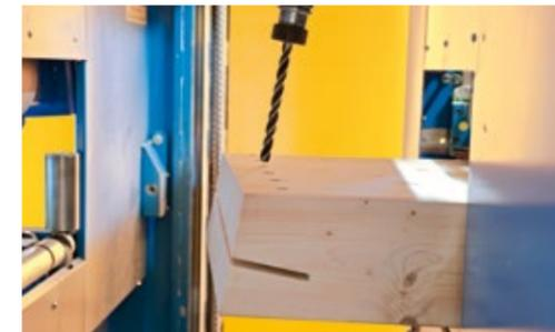
Ein in Längsrichtung verfahrbarer Tisch auf der Auslaufseite sorgt dafür, dass das Bauteil immer möglichst eng eingespannt ist und so unnötige Vibrationen beim Bearbeiten vermieden werden. In Verbindung mit dem hohen Drehzahlbereich des ROBOT-Aggregates entstehen dadurch Oberflächen in Sichtqualität.
