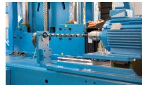
Optional können auf das ROBOT-Aggregat bis zu 2 horizontal arbeitende Bohrgeräte installiert werden. Damit lassen sich ohne Werkzeugwechsel Bohrungen für Sparrennägel, Pfettenaufdopplungen etc. bis max. 525 mm Tiefe fertigen.
