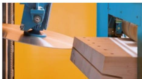
Im Gegensatz zu einer Lösung mit Unter-tischkappsäge kann das Sägeblatt unter die 0-Position schneiden und Schlitzte in beliebigen Winkeln und in allen benötigten Stärken fertigen.
