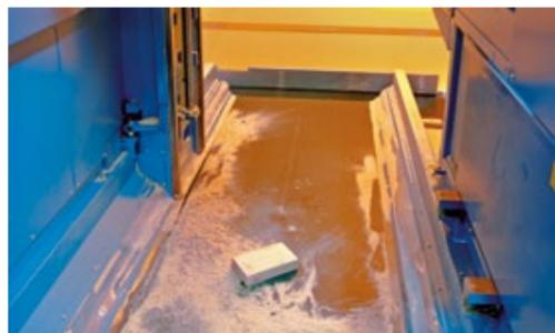
Alternativ steht für eine sichere Trennung von kurzen Gutteilen und Reststücken auch eine gesteuerte Bandlösung zur Verfügung.
